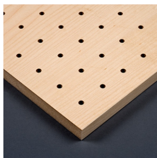
Kiểu: E16/3-15 Remak Linear Hole Khoảng cách lỗ tiêu âm 16mm Đường kính lỗ mặt 3mm Đường kính lỗ sau 10mm Chiều dày 15mm
