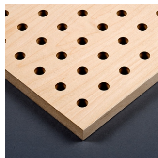
Kiểu: RH-L32/6-15 Remak Linear Hole Khoảng cách lỗ tiêu âm 16mm Đường kính lỗ mặt 6mm Đường kính lỗ sau 10mm Chiều dày 15mm
